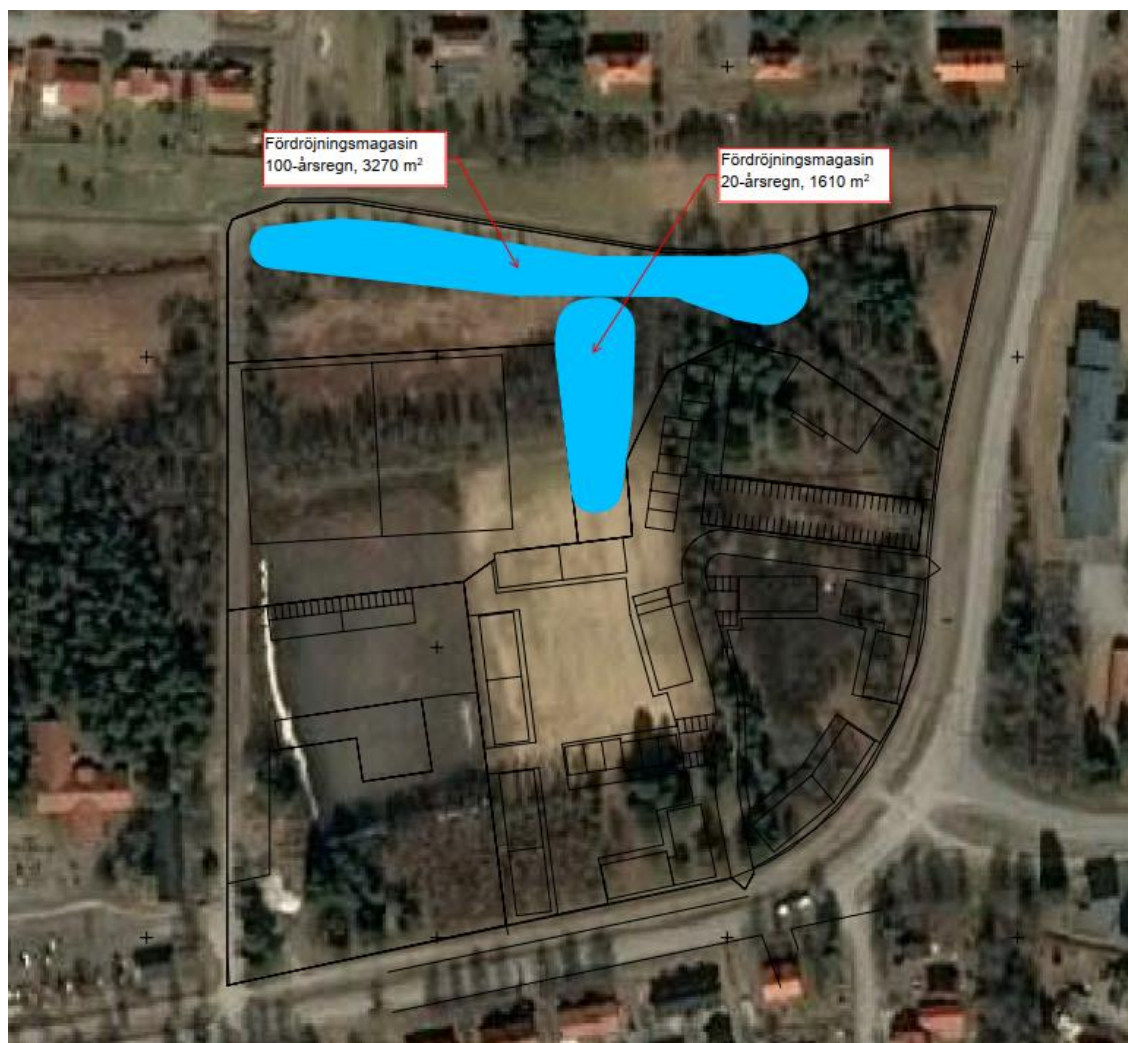
Figur 1. Ytbehov för att fördröja ett 20- respektive 100-årsregn med en reglerhöjd på 0,5 meter.
