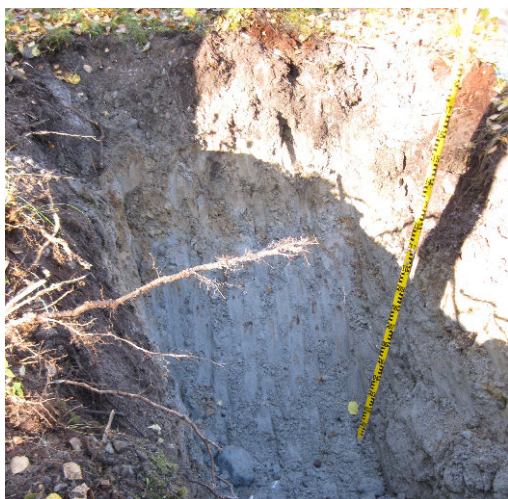
Fig.13. Långgrundets Brädgårdsområde från provgrop nr 3, vegetationsskikt är generellt relativt tunt över delområdet
