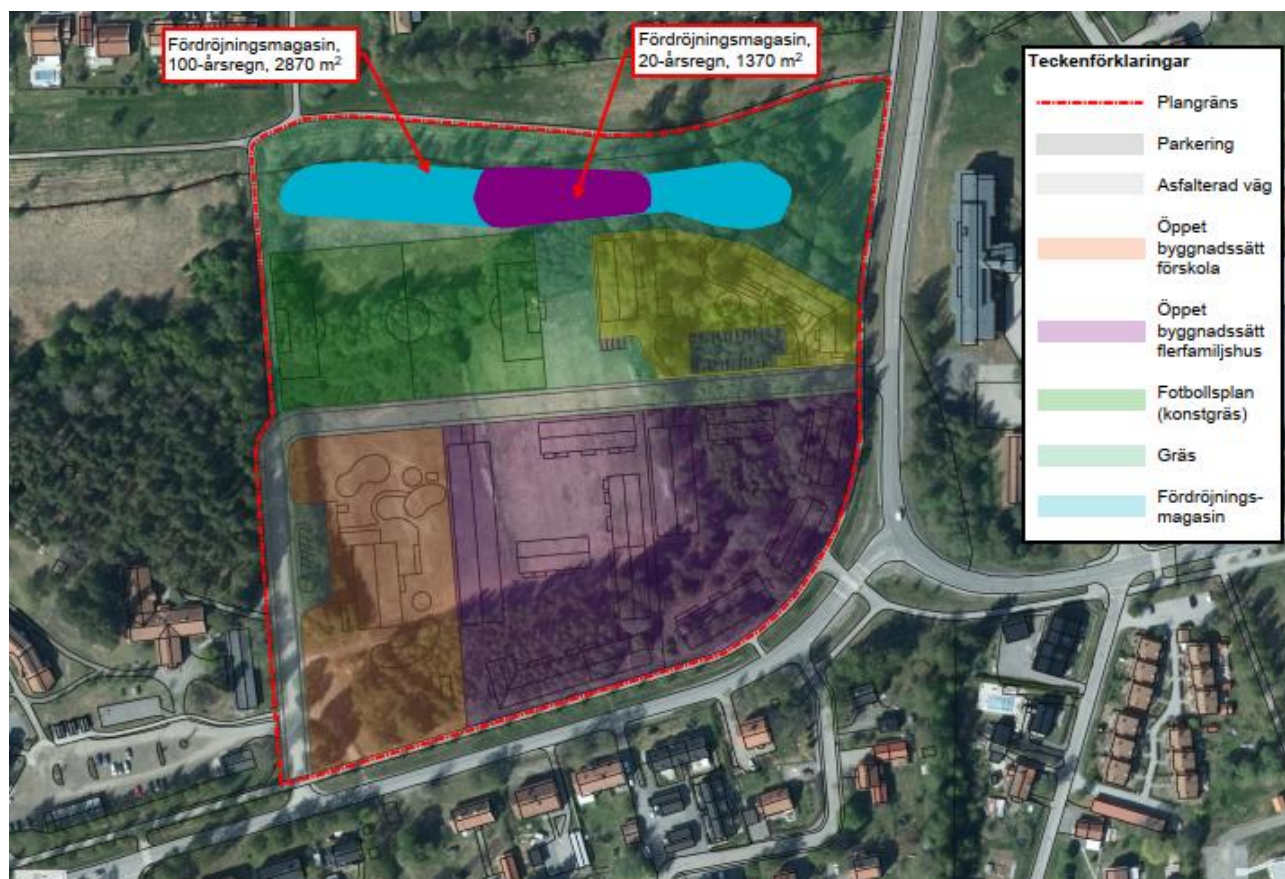
Figur 1. Ytbehov för att födröja ett 20- respektive 100-årsregn med en reglerhöjd på 0,5 meter.
